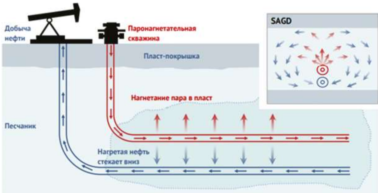
Рисунок 1. Схема метода парогравитационного дренажа
